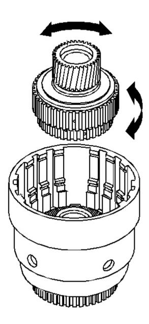
Fig. 175: Checking Sun Gear Rotation
