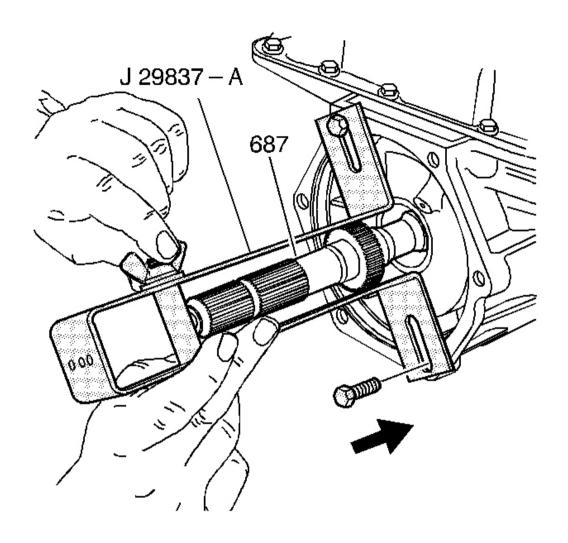
Fig. 137: Installing J 29837-A
